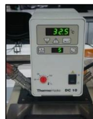
Figura 15. Sistema que controla e mantém a temperatura a  $32,5^\circ\text{C}$ .
