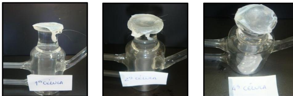
Figura 18. Porções de pele de porco elegidas para usar no ensaio de permeação.
