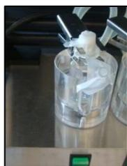
Figura 14. Garra metálica adaptada entre o compartimento dador e receptor de forma a fechar o sistema.
