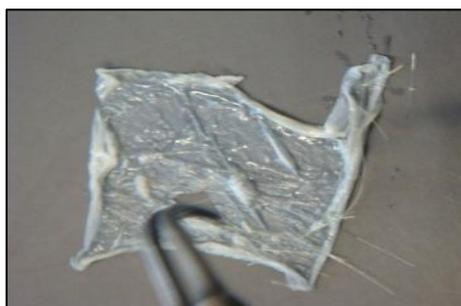
Figura 16. Ilustração das porções de pele de porco usadas no ensaio de permeação.
