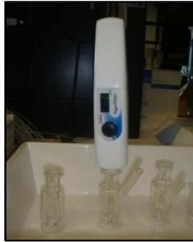
Figura 17. Medição da TEWL usando o aparelho *Delfin Vapometer*.
