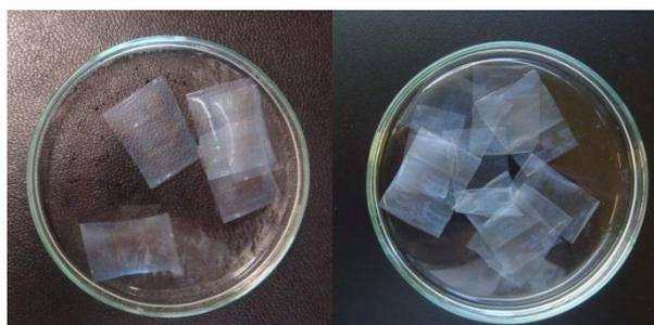
Figura 11. Membranas de Dialysis Tubing Celulose (33 mm).
