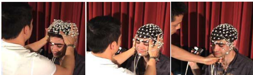
Figura 4-3. Colocação da HydroCel GSN (HCGSN)
