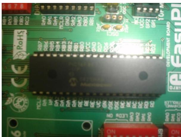
Figura 4 – Microcontrolador *PIC18F4620*.
