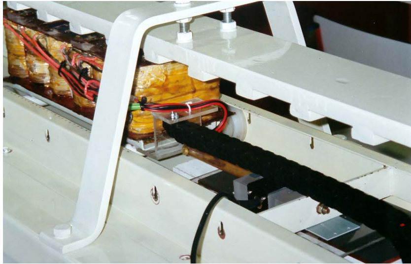
Fig. 7.15 Pormenor do processo de bloqueio do secundário do actuador nas posições pretendidas.
