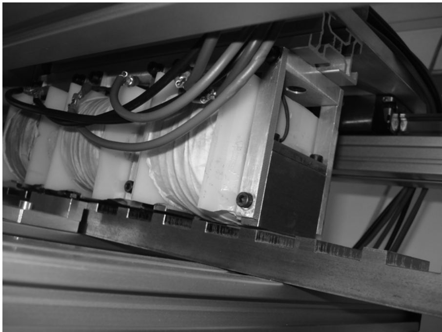
Fig. 5.12 – Pormenor do primário do actuador linear de RVC de três fases com circuitos magnéticos independentes
