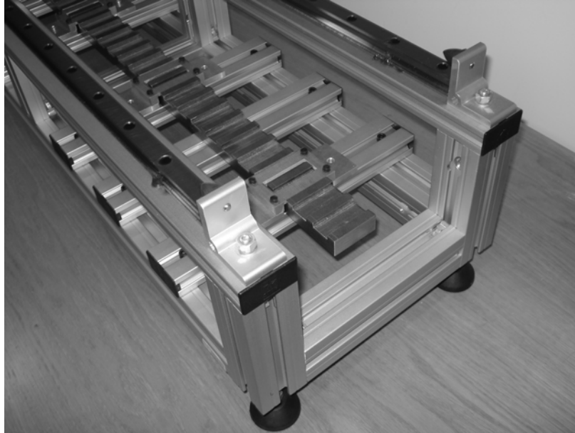
Fig. 5.11 – Estrutura de suporte com o secundário instalado
