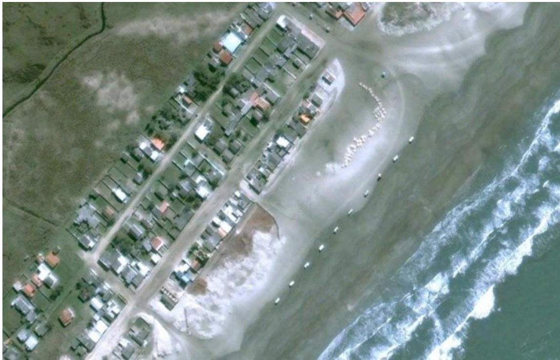
Figura 5: (a) Imagem orbital datada de 16/8/2006 identificando o período de início de contenção das dunas frontais no balneário do Mar Grosso onde foram inseridas pequenas quantidades de areia junto à praia, em forma de “L” e galhos e ramos de podas na extensão longitudinal da orla. Fonte: Google Earth PRO®.
