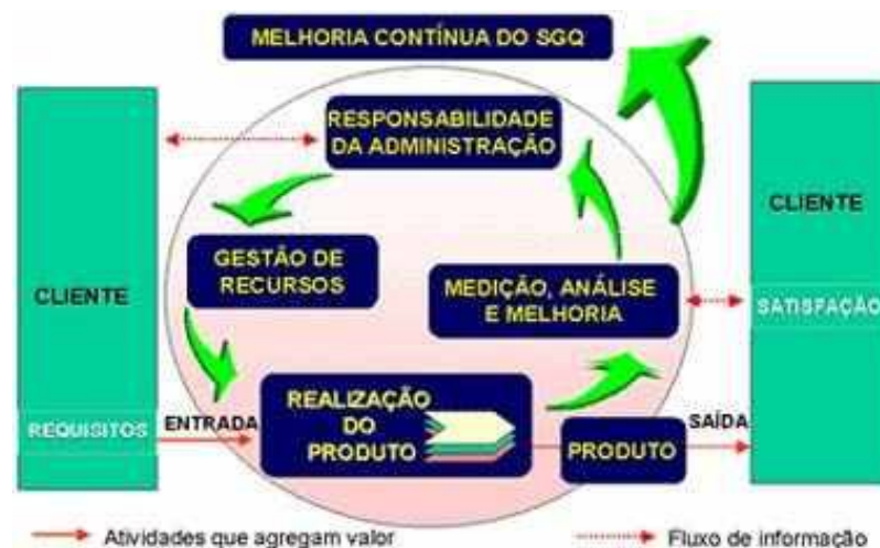
Figura 7 – Modelo de um SGQ baseado em processo conforme ISO 9001 Fonte: ABNT NBR ISO 9001:2000
