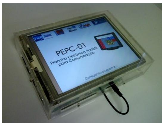
**Figura 2. Protótipo de testes com *kit* de desenvolvimento AT91RM9200-EK.**
