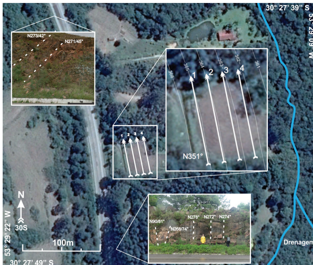
Figura 3. Imagem aérea da área de pesquisa com o posicionamento e orientação das linhas de tomografia de resistividade elétrica em relação ao fraturamento e ao relevo local.
