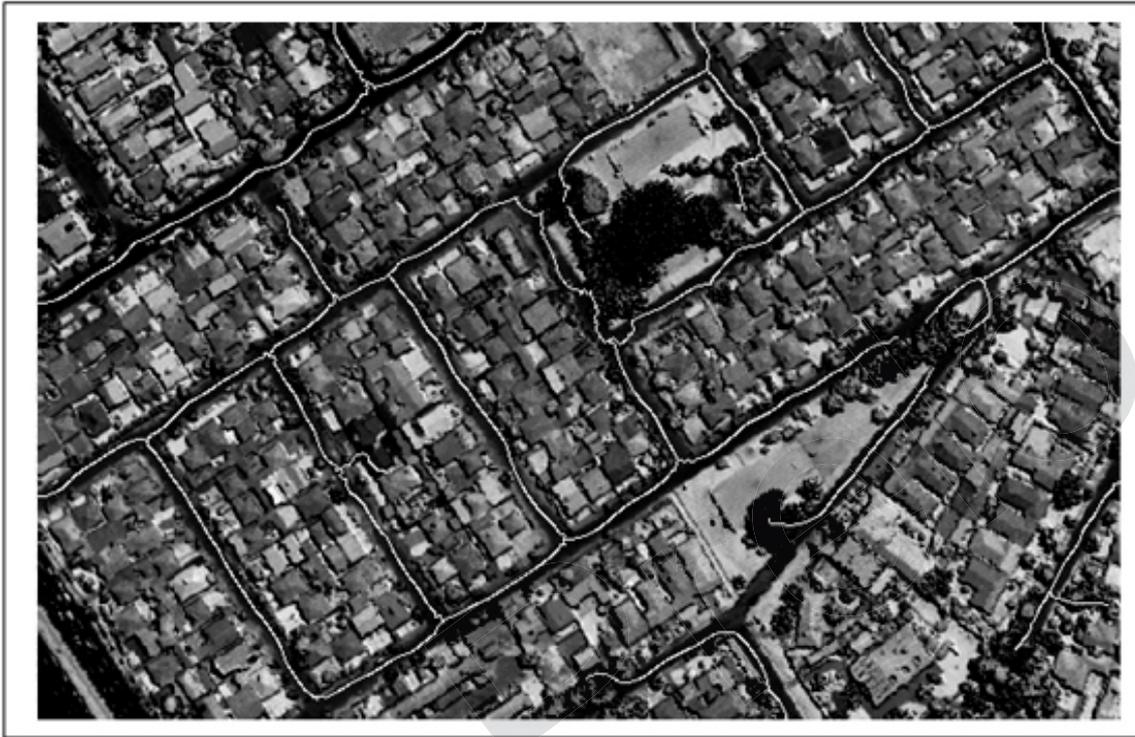
Figura 11. Eixo médio das vias usando detector de linhas de Steger.
