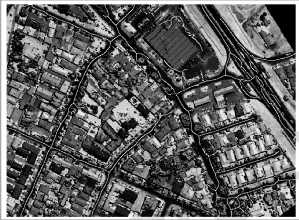
Figura 16. Eixo médio das vias usando o detector de linhas de Steger.
