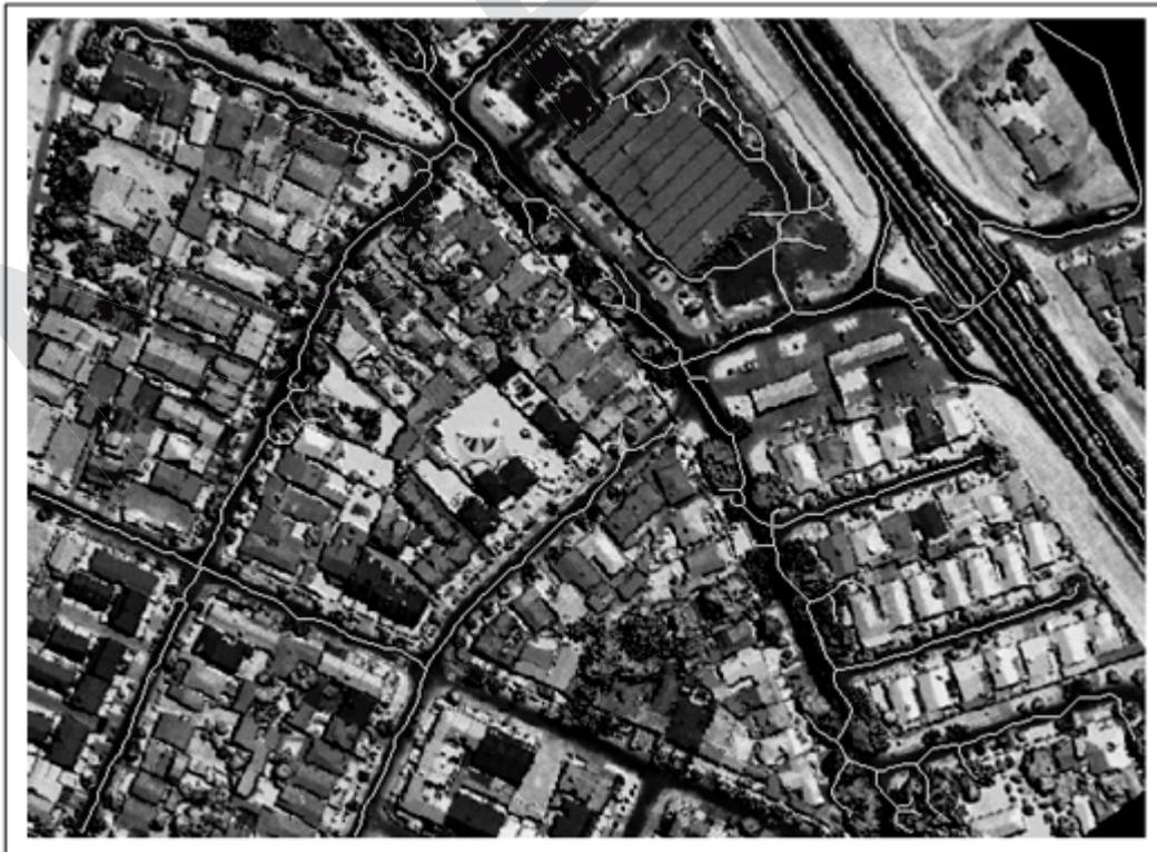
Figura 17. Eixo médio das vias usando o método de esqueletização.
