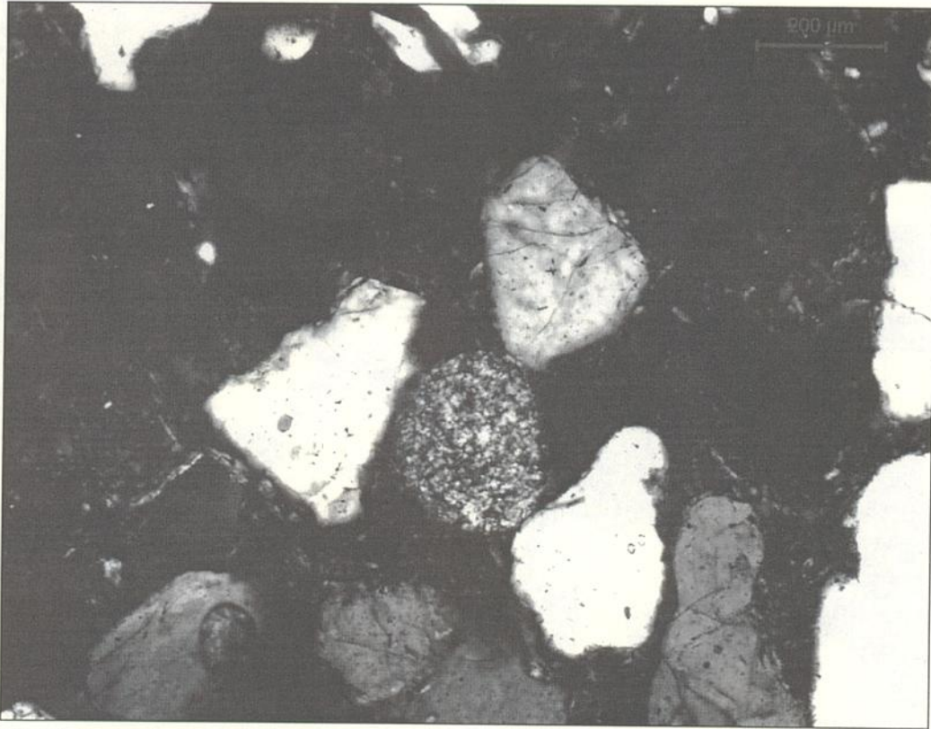
Figura 3 - Mesmo clasto de argila da figura anterior, observado a nicóis cruzados. A cor de interferência argilomineral é amarelada, compatível com a birrefringência da glauconita. O lado maior da imagem equivale a 1,46 mm.
