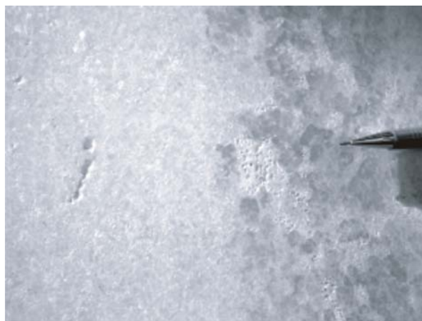
Figura 5 – Aspecto geral das chapas de mármore do revestimento da Cúpula ressaltando a textura granoblástica grossa e o início da dissolução de cristais de calcita.
