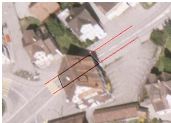
Figura 7 - Obstrução causada pela projeção perspectiva da estrutura do edifício nos limites da via.
