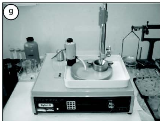
Figura 10 - Exemplo de polimento progressivo de um conjunto de amostras (a), passando por todos os estágios físicos de abrasão e químico-físico (última amostra). As figuras (b, c, d, e & f) referem-se as politrizes utilizadas nos diferentes tamanhos de grão de abrasivo (230 grit, 50 grit, pasta de diamante de 9, 3 e 1 \mu\text{m} , respectivamente). A foto (g) mostra a politriz utilizada no processo químico-físico de ataque com sílica coloidal (SYTON®).
