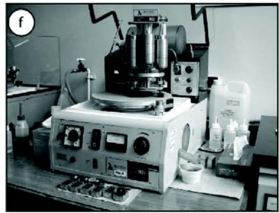
Figura 10 - Exemplo de polimento progressivo de um conjunto de amostras (a), passando por todos os estágios físicos de abrasão e químico-físico (última amostra). As figuras (b, c, d, e & f) referem-se as politrizes utilizadas nos diferentes tamanhos de grão de abrasivo (230 grit, 50 grit, pasta de diamante de 9, 3 e 1 \mu\text{m} , respectivamente). A foto (g) mostra a politriz utilizada no processo químico-físico de ataque com sílica coloidal (SYTON®).
