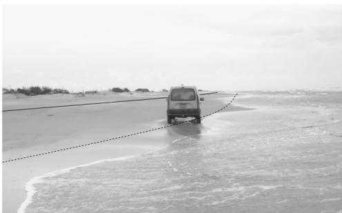
Figura 2 - Levantamento longitudinal do perfil de praia utilizando GPS. A trajetória do monitoramento está representada pela linha tracejada – a linha d'água associada ao espraiamento da onda e a linha contínua – localizada entre a duna frontal e a linha d'água.
