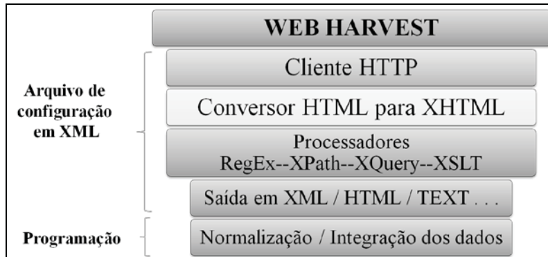
Figura 6: Visão geral da arquitetura da aplicação Web-Harvest .
