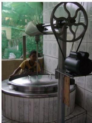
Figura 36: Agroindústria e tacho de inox com pá mecânica.
