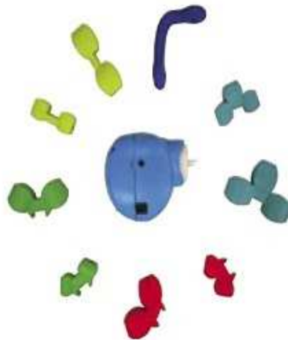
Figura 1 - Conjunto de peças ativas e passivas que formam o Topobo .
