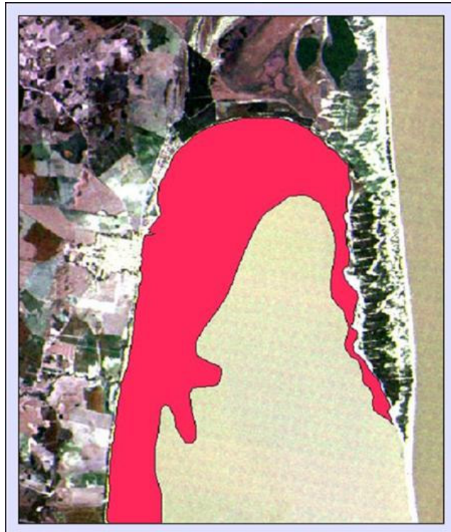
Figura 1 - Áreas de profundidade inferior a 2m.
