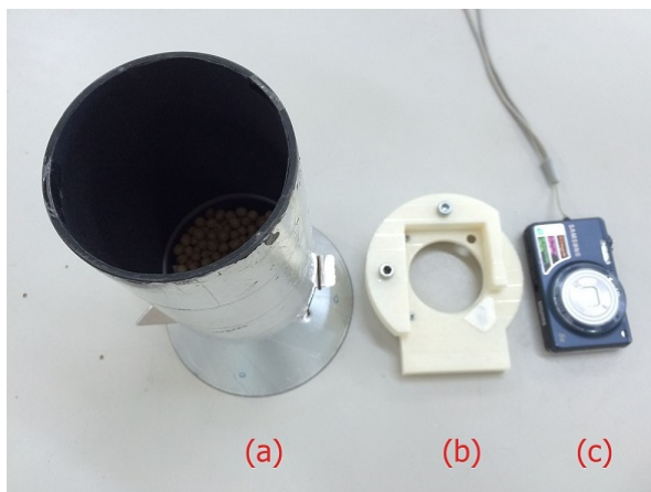
Figura 1: A) o copo revestido com algumas sementes, b) o fixador da câmera no copo feito em uma impressora 3D e a c) câmera utilizada.
