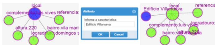
Figura 12. Representação do processo de inserção de uma parte de informação situacional diretamente no Grafo da Situação
