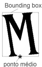
Figura 4. Algoritmo de Baird: apenas o ponto médio superior do bounding box é projetado.
