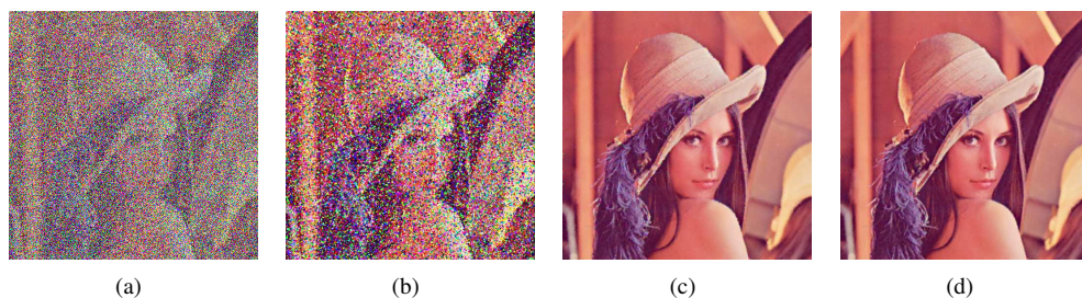
Figura 8. Imagens Lena: (a) com 70% de ruído impulsivo, (b) restaurada com o SMF, (c) restaurada com o FMS e (d) restaurada com o método proposto.
