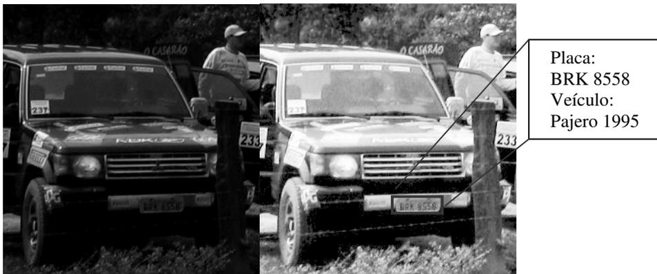
Fig. 1: Veículo em imagem escura (esquerda). Após uma equalização de histograma, em nível de cinza, onde a placa do veículo pode ser lida (direita). Informação da placa e do veículo no retângulo.
