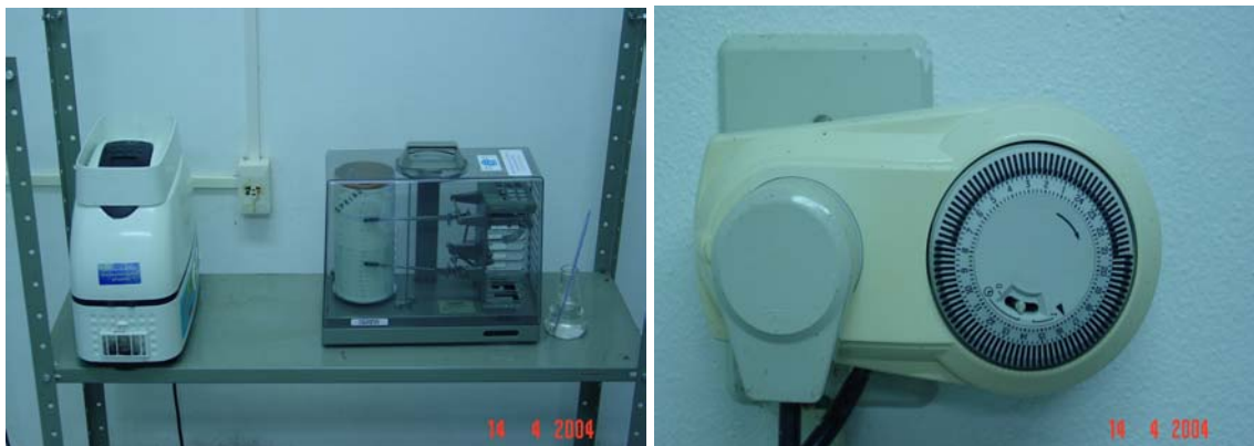
Figura 10. Aparelhos responsáveis pela manutenção e monitoramento da temperatura, umidade relativa do ar e fotoperíodo, respectivamente. Laboratório de Entomologia, Estação Experimental de São Joaquim.
