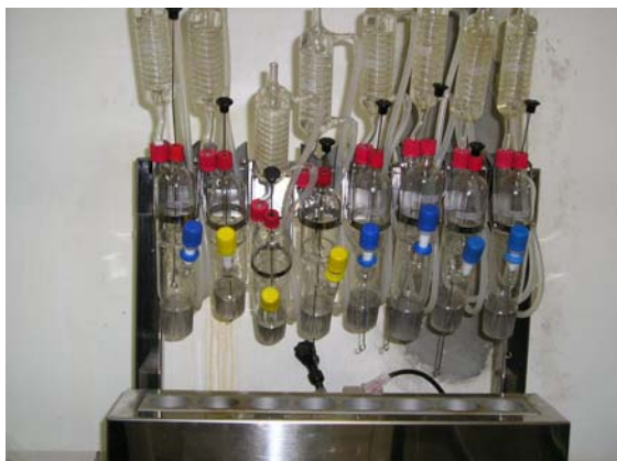
Figura 04: Aparelho para Determinação de Gordura Bruta.
