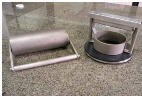
Figura 08: Aparelho Cobb Teste para determinação da durabilidade do papelão.
