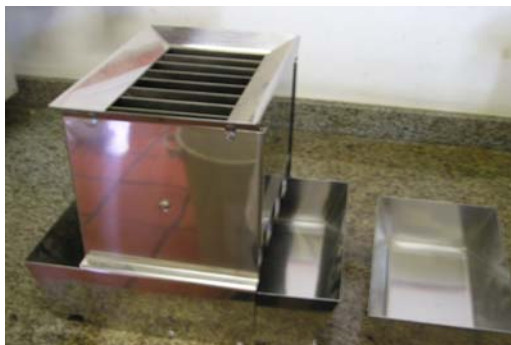
Figura 02: Quarteador utilizado na homogeneização de amostras.
