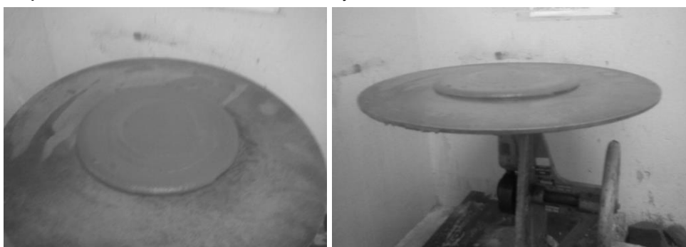
Figura 2 - Aspecto do SCAA no ensaio de determinação do índice de consistência
