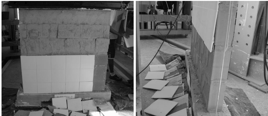
Figura 11 - Paredes cerâmicas sem emboço: descolamento do revestimento
