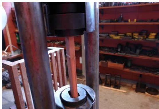
Figura 1 - Ensaio de tração para avaliação da resistência da emenda dentada
