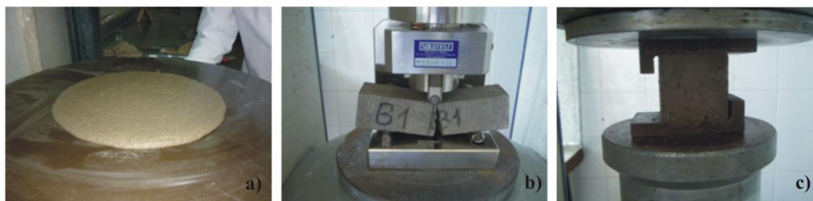
Figura 2 - Ensaios da argamassa: (a) consistência; (b) tração na flexão; e (c) compressão
