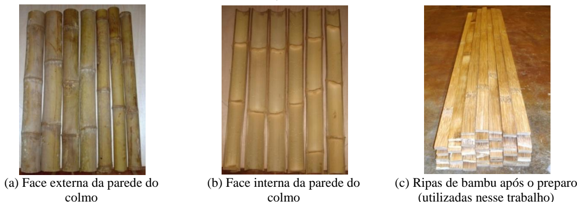
Figura 1 - Detalhes dos produtos de corte e laminação do bambu
