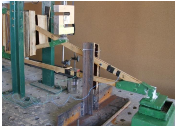
Figura 7 - Detalhe da contenção lateral na treliça ensaiada
