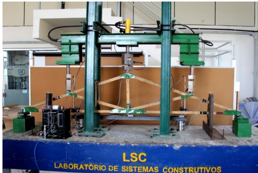
Figura 8 - Arranjo experimental utilizado no ensaio das treliças planas tipo Howe
