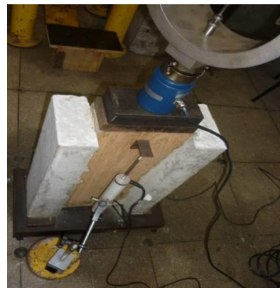
(b) Instrumentação com transdutores de deslocamento
