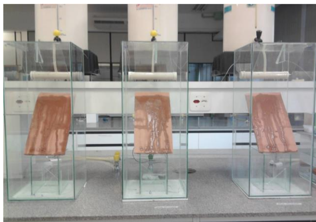
Figura 4 - Teste de lixiviação por irrigação em execução
