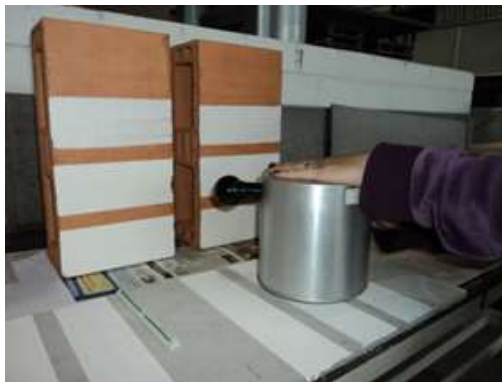
Figura 3 - Medida de emissividade térmica
