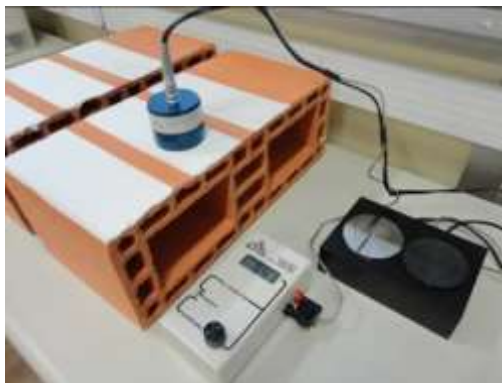
Figura 3 - Medida de emissividade térmica
