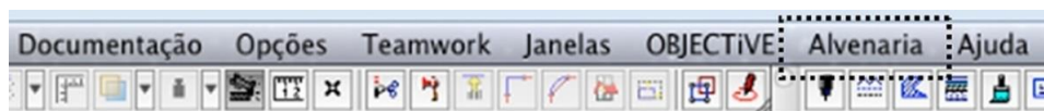
Figura 7 - Nova ferramenta “Alvenaria”, criada pelo plug-in no menu original do software ArchiCAD
