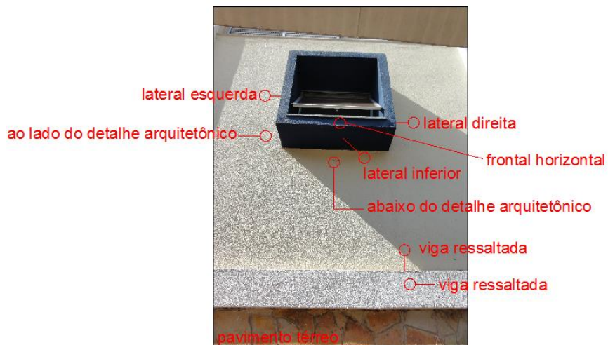
Figura 5 - Exemplo da localização da nomenclatura utilizada para fazer referência aos pontos onde foram realizadas as medições de temperatura superficial
