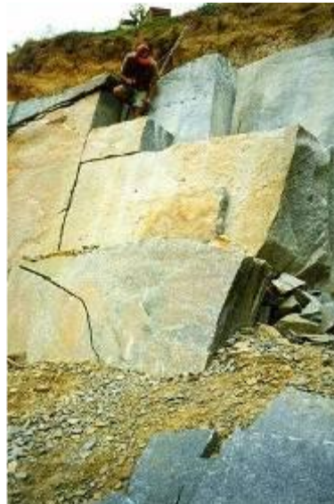
Figura 2 - Ponteamento manual para retirada do bloco
