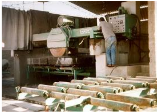
Figura 13 - Corte dos blocos com a serra circular
