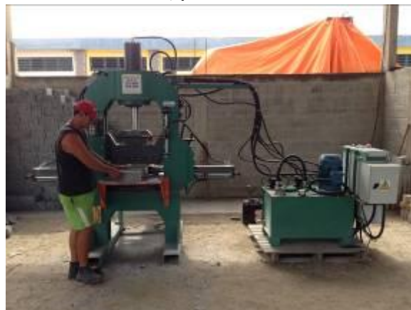
Figura 19 - Máquina de acionamento hidráulico, para abrir blocos de rochas ornamentais
