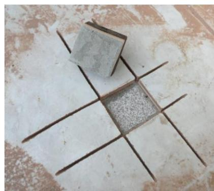
(a) Percentual médio de argamassa na superfície dos substratos após o ensaio de resistência de aderência, obtidos por análise visual da interface
