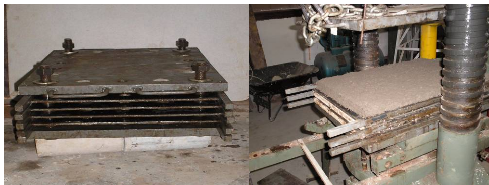
Figura 5 - Molde metálico e formação do colchão de cimento-madeira
