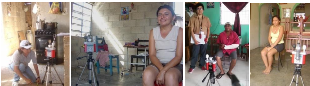
Figura 3 - Fotos de la aplicación de encuestas y monitor de estrés térmico
