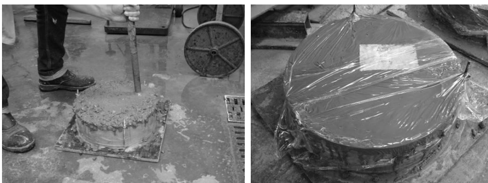
Figura 3 - Moldagem dos corpos de prova para o ensaio de abrasão
