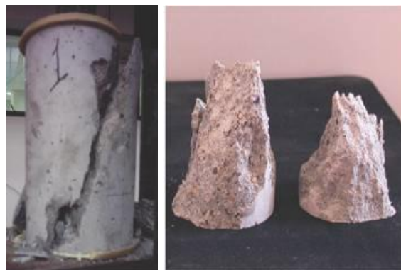
Figura 5 - Modos de ruptura do concreto submetido a carregamento de compressão - (a) plano de cisalhamento a 45° e (b) ruptura em forma de cone
