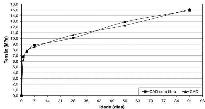
Figura 5 - Resistência à flexão dos CAD com e sem adição de fibra de polipropileno
