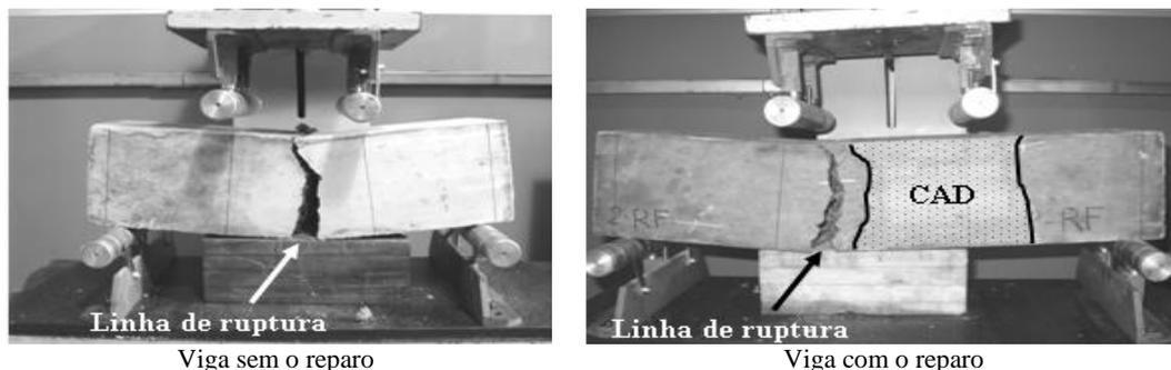
Figura 6 - Ensaio de tração na flexão
