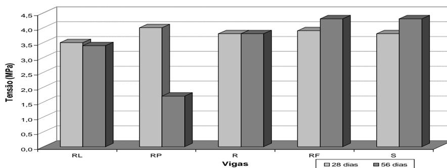
Figura 7 - Resistência à tração na flexão das vigas
