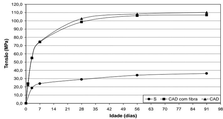
Figura 3 - Resistência à compressão axial simples dos concretos elaborados
