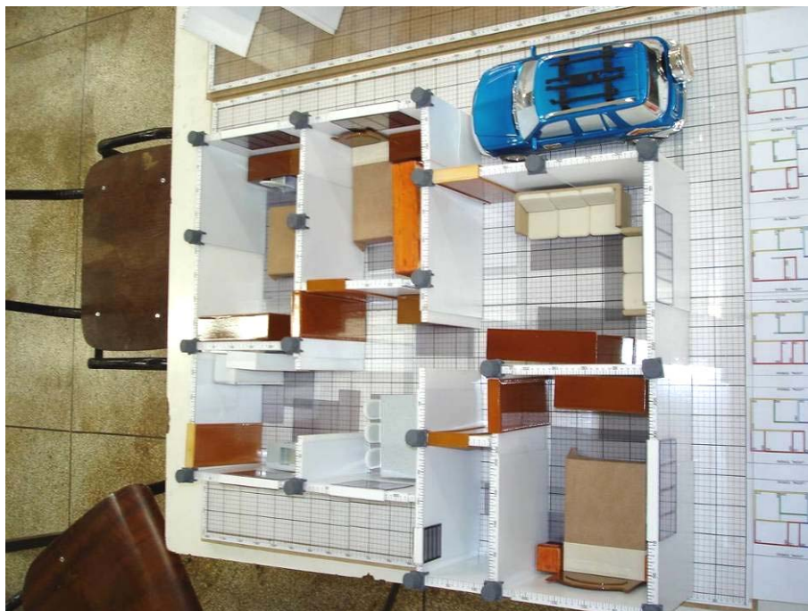
Figura 4 - Exemplo de um modelo tridimensional finalizado com seus ambientes internos, indicação de estrutura, dos mobiliários e das esquadrias
