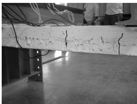
Figura 11 - Fissuras nas faces inferior e lateral do protótipo PCR, concentradas na região central e espaçadas de 25 cm
