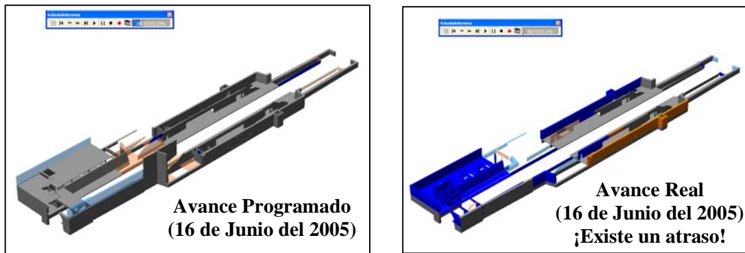
Figura 3 - Seguimiento y control visual de la obra gruesa (detección y solución de atrasos)
