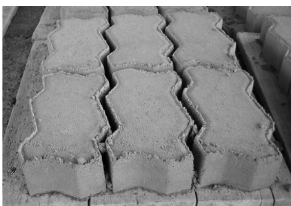
Figura 4 - Blocos de concreto segmentados com 16 faces
