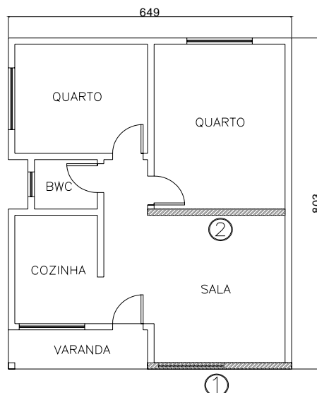
Figura 5 - Determinação do coeficiente de isolamento acústico de divisória interna e da fachada
