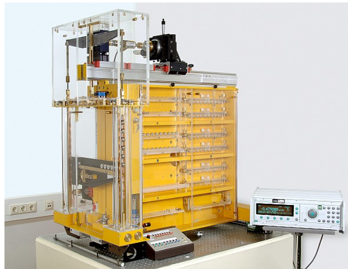
Figura 7 - Padrão Primário de Torque 1Nm (Fonte: PTB)
