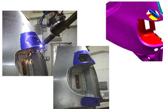
Figura 2 - Aplicação de corte a plasma no Crossfox
